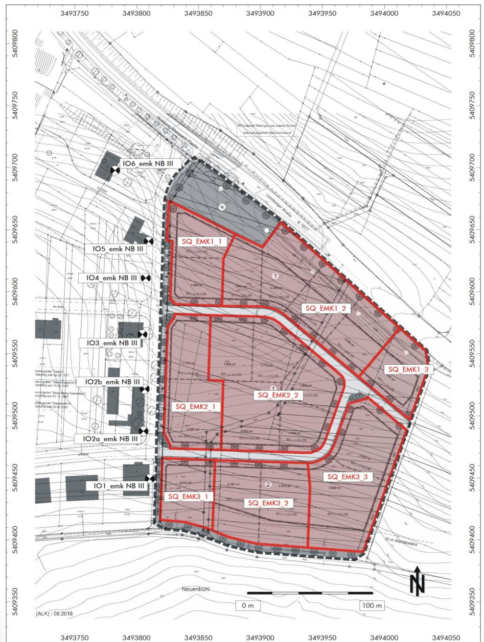
Bild 2: Rechenmodell Emissionskontingentierung mit Lage der berücksichtigten Schallquellen und Immissionsort (Maßstab ca. 1: 3.000)
